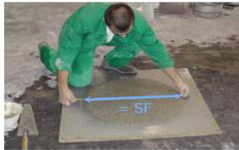
Figure I.6 : essai d'étalement au cône (slump flow)
