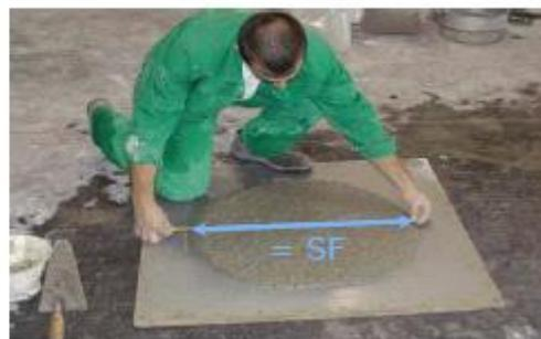
*Figure I.6 : essai d'étalement au cône (slump flow)*
