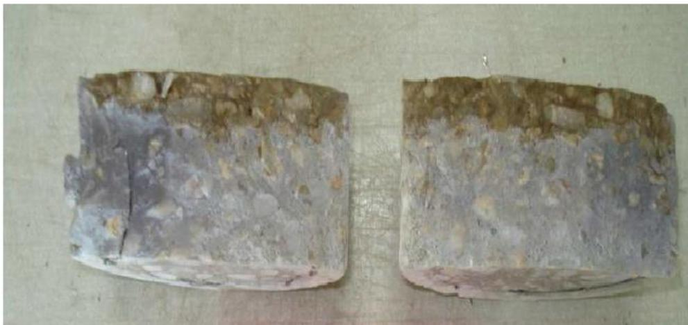
**Figure.II.2 : Eprouvettes affectées par les ions chlorures**
