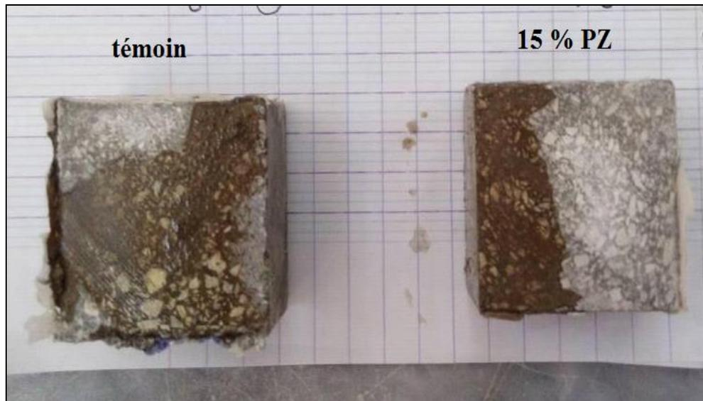
**Figure III.11:** *Comparaison de la profondeur des ions chlore entre MAP 0%PZ et MAP15%PZ En immersion totale à 28jours (De gauche à droite) respectivement.*
