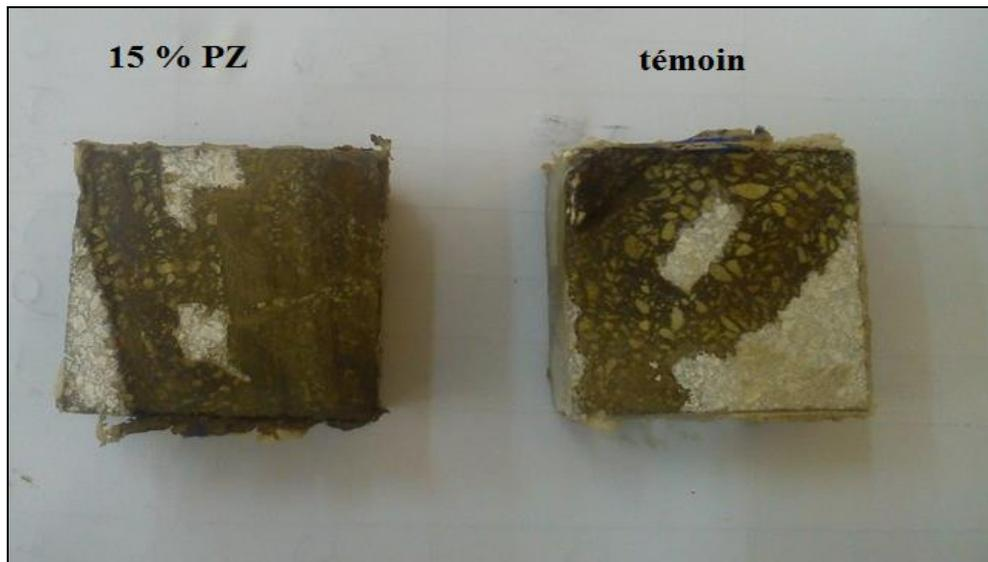
**Figure III.13: Comparaison de la profondeur des ions chlore entre MAP 0%PZ et MAP15%PZ En immersion totale à 90 jours (De droite à gauche) respectivement.**
