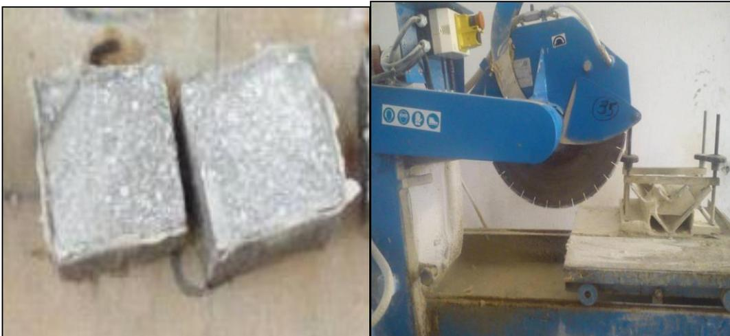
*Figure III.2: Coupe de l'éprouvette en deux après 28,56 et 90 jours d'immersion (totale).*
