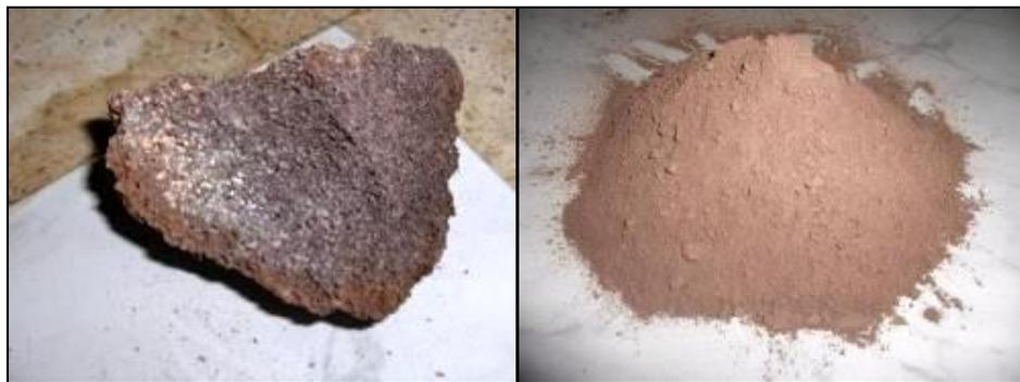
**Figure II.1: Scories de la pouzzolane Naturelle de Beni-Saf avant broyage. Figure II.2: Poudre de la pouzzolane Naturelle de Beni-Saf après broyage, < 80 µm.**
