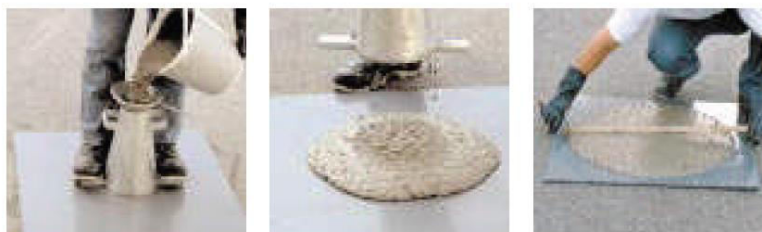
Photo 1.2 : Étapes de l'essai d'étalement au cône d'Abrams [HOLCIM 2004]
