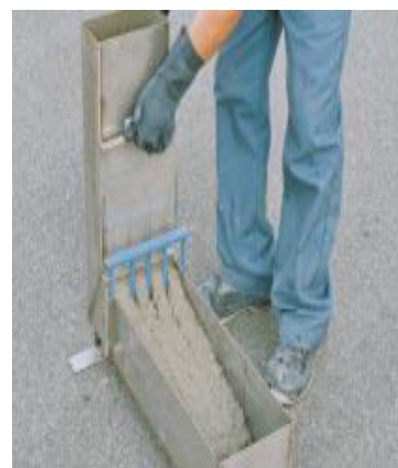
Photo 1.4 : Déroulement de l'essai de boîte en L [HOLCIM 2004]
