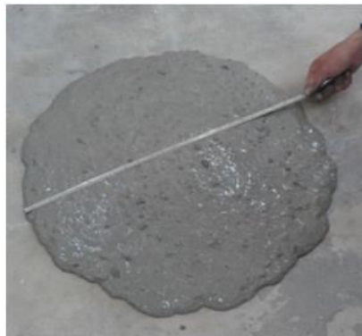
Photo 3.7 : Essai de l'étalement au cône d'Abrams
