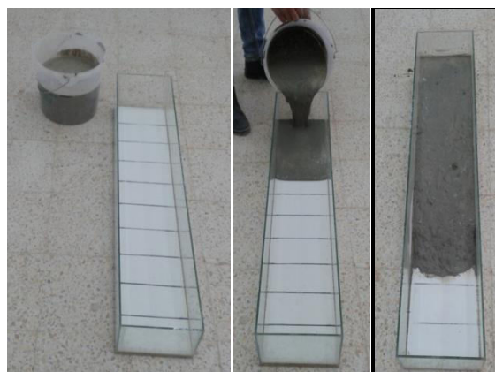
Photo 3.8 : Essai de la boîte LCPC
