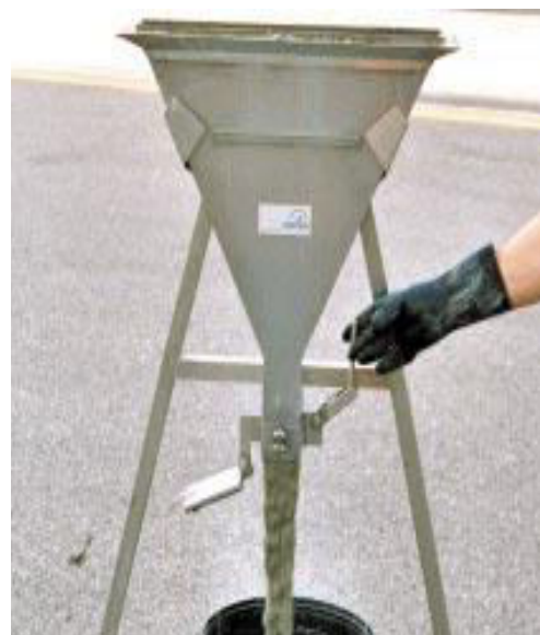
Figure 1.8 : Essai de l'entonnoir en V [K. KHAYAT] Photo 1.7 : Déroulement de l'essai d'entonnoir en V
