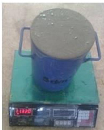
Photo 3.6 : Essai de la compacité des bétons
