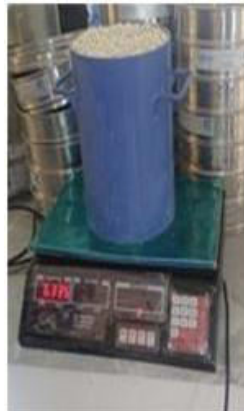
Photo 3.5 : Essai de la compacité des graviers
