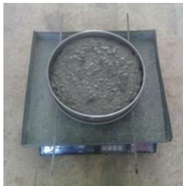
Photo 3.10 : Essai de la résistance à la ségrégation au tamis
