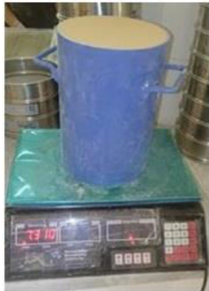
Photo 3.4 : Essai de la compacité des sables
