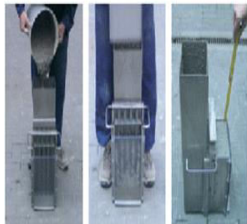
Photo 1.5 : Étapes de l'essai de boîte en U
