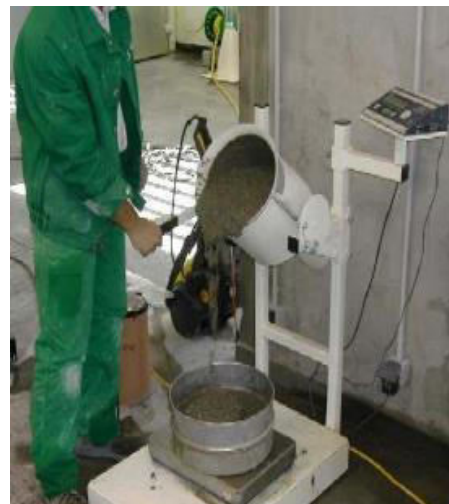
Figure 1.9 : Essai de la stabilité au tamis Photo 1.8 : Déroulement de l'essai de stabilité au tamis [Z. ABIB & al.]
