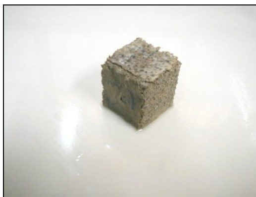
Figure 3.8 : Etats d'échantillons immergés pendant 28 jours Dans 5% HCl
