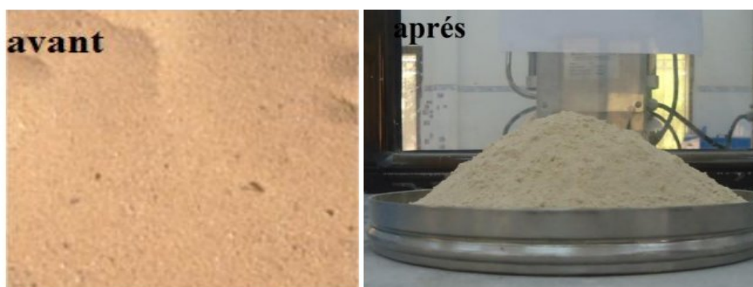
Figure .2.5: Le sable de dune avant et après broyage.
