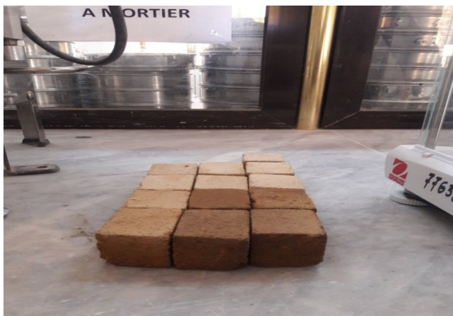
Figure 3.7 : Etat des éprouvettes après immersion de 28 jours dans Solutions : témoin, 5 % HCl
