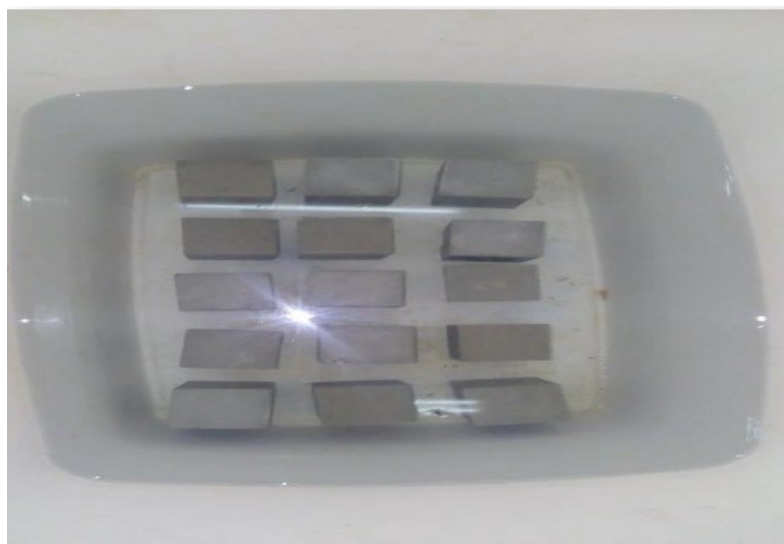
Figure 3.9 : Immersion d'éprouvettes en solution de 5% MgSO_4 .
