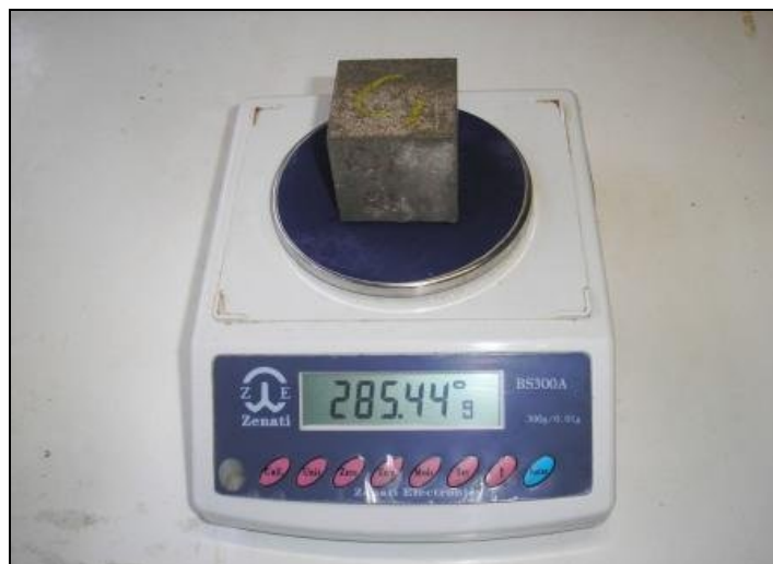
Figure3.4 : Pesée des échantillons. Balance de précision 0.01g.
