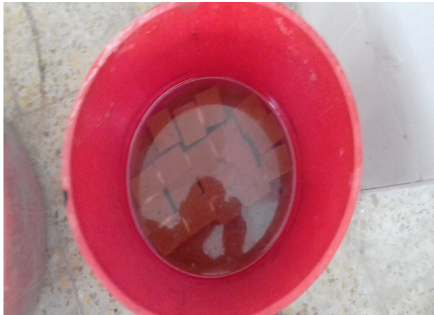
Figure 3.3 : Mortiers immergés dans la solution acide.
