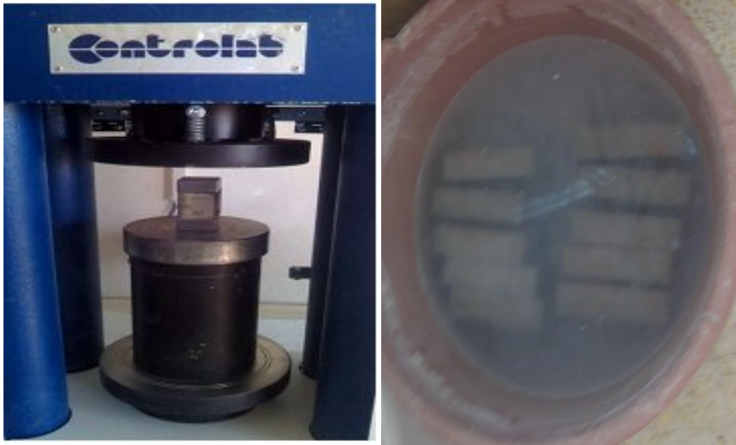
Figure 2.8: la presse hydraulique de compression pour mortier (Laboratoire des LNHC Djelfa)
