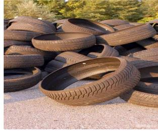
**Fig.2.7.** *Pneus avec un seul flanc*
