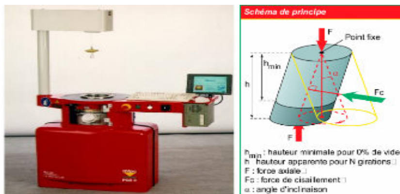
Figure II.14 Presse à cisaillement giratoire (PCG)
