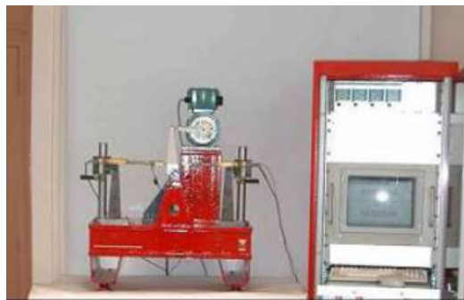
Figure II.20. Essai de fatigue en flexion 2 points sur éprouvettes trapézoïdales
