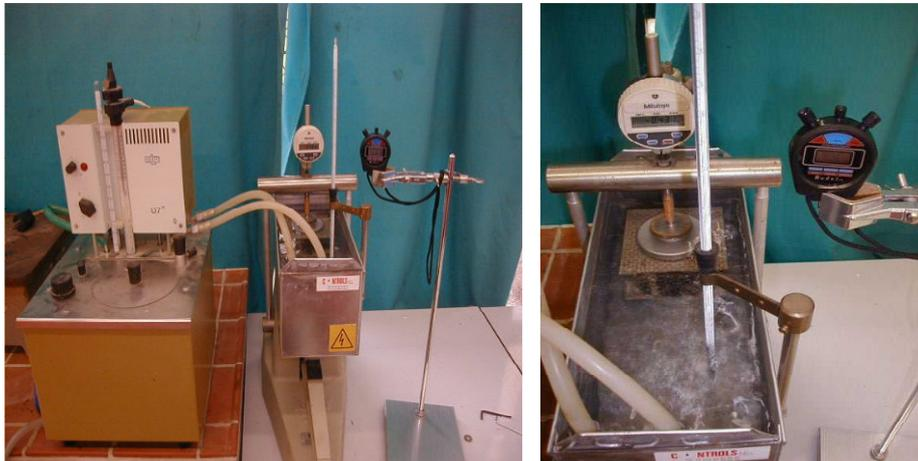
Figure. VI.2.Appareillage mis au point en laboratoire et utilisé pour les essais de fluage sur enrobés bitumineux
