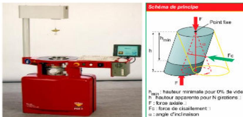
Figure II.14 Presse à cisaillement giratoire (PCG)
