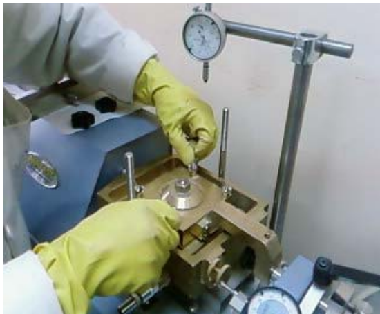
Photo. II.10: Emplacement de la boîte sur la machine de cisaillement
