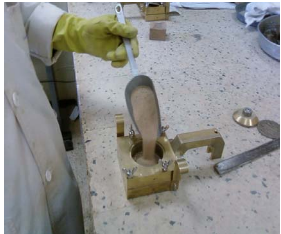
Photo. II.9: Versement du sable dans la boîte
