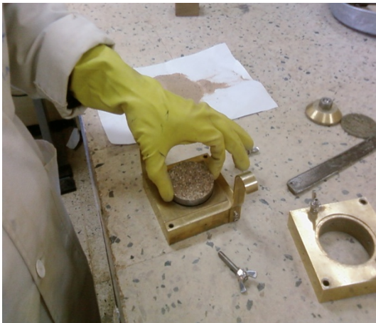
Photo. II.6: Pose de la structure dans la partie inférieure (Acier à surface rugueuse)
