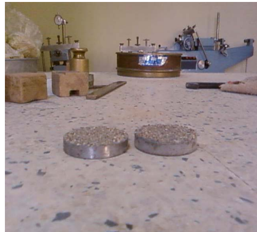
Photo. II.7: Surface rugueuse en acier et en béton
