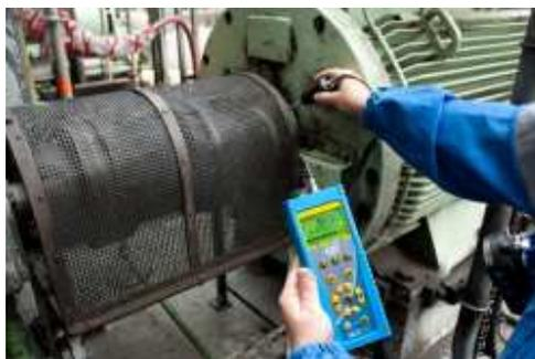
**Figure. I.6 : Capteurs de vibration à ultrasons [79]**
