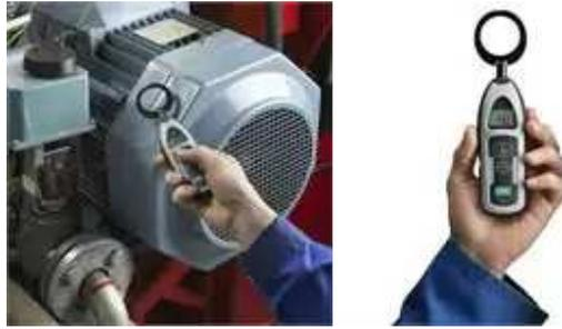
**Figure. I.14 : Détecteur de décharge électrique [91]**
