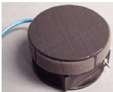
**Figure. I.9: Capteur acoustique MEMS (Micro Electro-Mechanical Systems) [83]**
