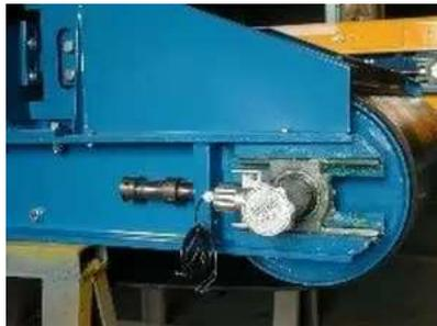
**Figure. I.10 : Capteur de vitesse angulaire [84]**
