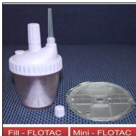
Figure 1. Kits Fill-FLOTAC et Mini- FLOTAC [BARDA et al. , 2013b].
