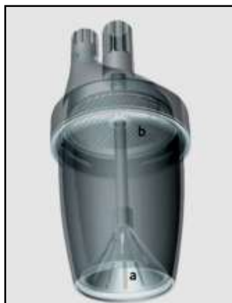
Figure 2. Composants de Fill-FLOTAC: Collecteur (a), filtre (b) [CRINGOLI et al. , 2010].
