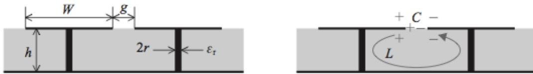
Fig. 2.9. Structure SHI. (a) paramètre de la structure, (b) son modèle LC.
