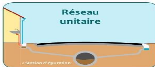
Figure II.1 : Le réseau unitaire (Bessedik M ,2015)
