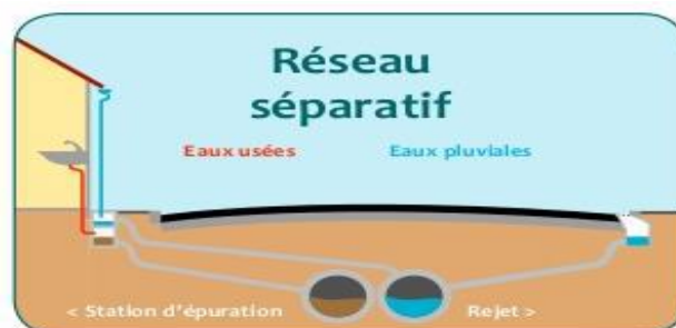
Figure II.2 : Le réseau séparatif (Bessedik M ,2015)
