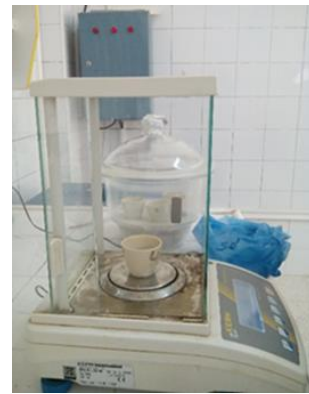
Les creusets + échantillon dans une balance
