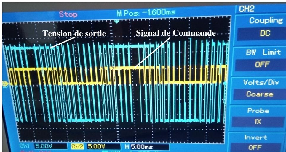
Figure 5.15 : Tension de sortie du convertisseur avec élimination du temps mort
