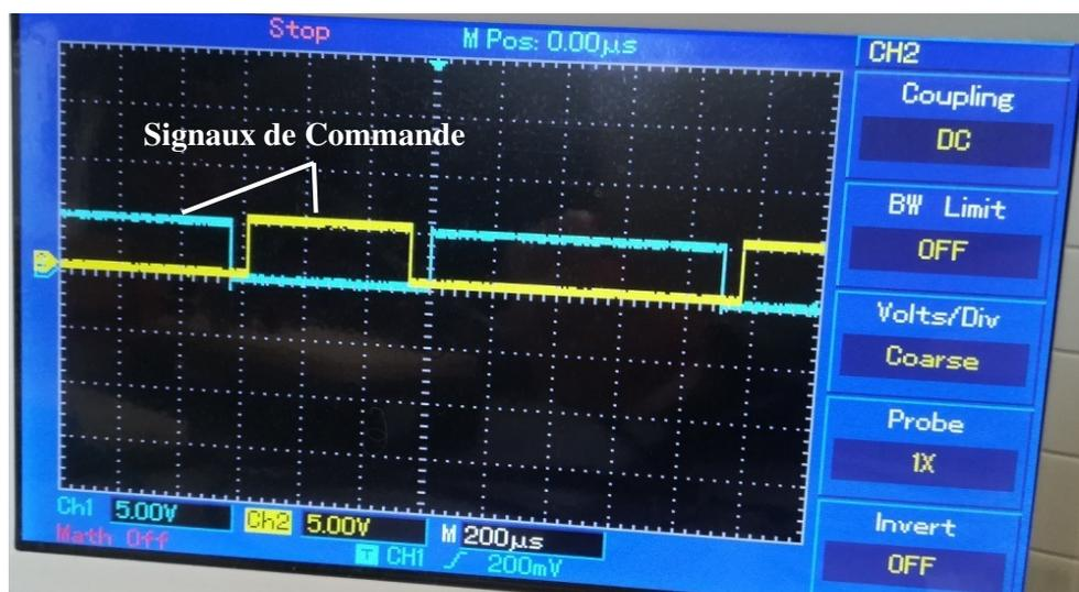
Figure 5.14 : Signaux de commande avec élimination du temps mort
