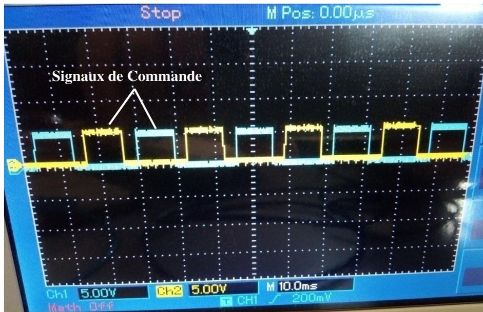
Figure 5.8 : Signaux de commande à pleine onde
