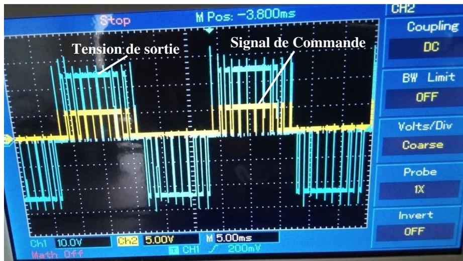
Figure 5.21 : Sortie du convertisseur pour une commande MLI unipolaire
