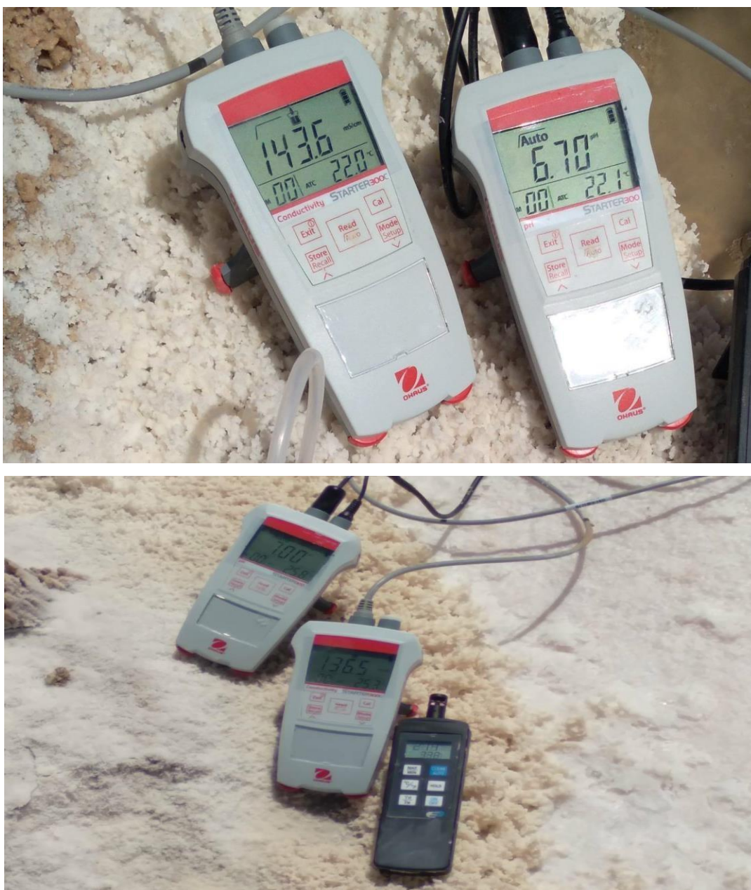
Figure 09: Matériel de mesure in situ de quelques paramètres physiques (pH, conductivité électrique et température).
