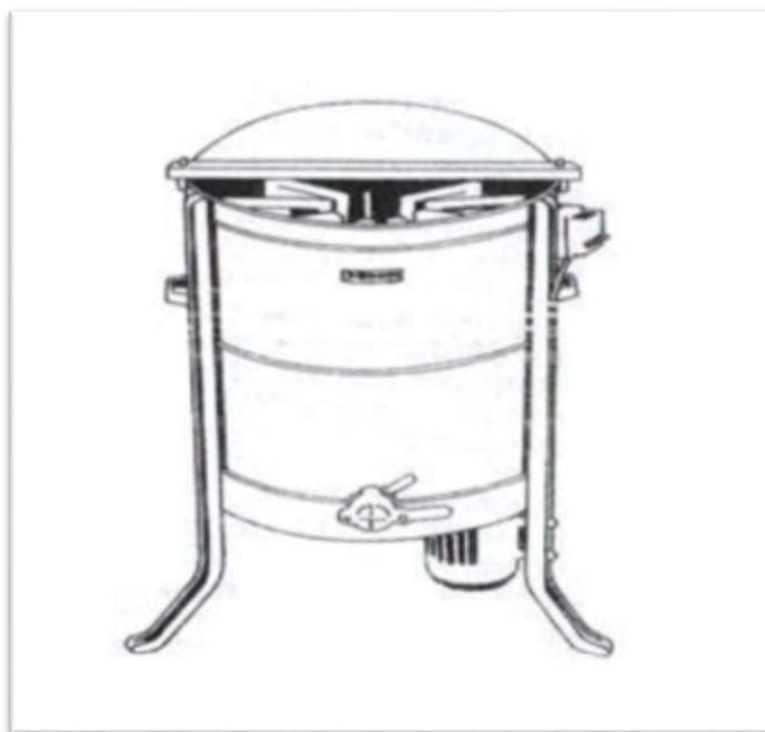
**Figure 2: Extracteur centrifuge à moteur électrique (Jean-prost et al., 2005).**
