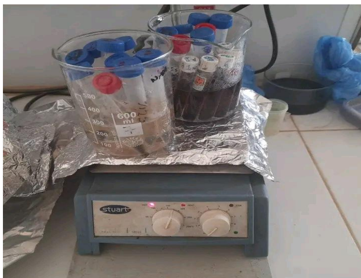
Figure 18 :Extraction du chrome hexavalent à partir des échantillons de sol
