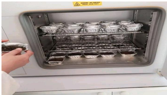
Figure 17 : placer les échantillons de feuilles et de racines et le sol à une température de 75°C
