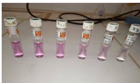
Figure 19 : Solutions standard de chrome hexavalent après contact avec 1.5 Diphénylcarbazine
