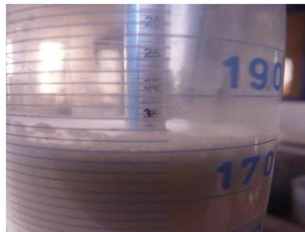
**Figure 4.1** Echantillon introduit dans un cylindre gradué et avec un thermomètre
