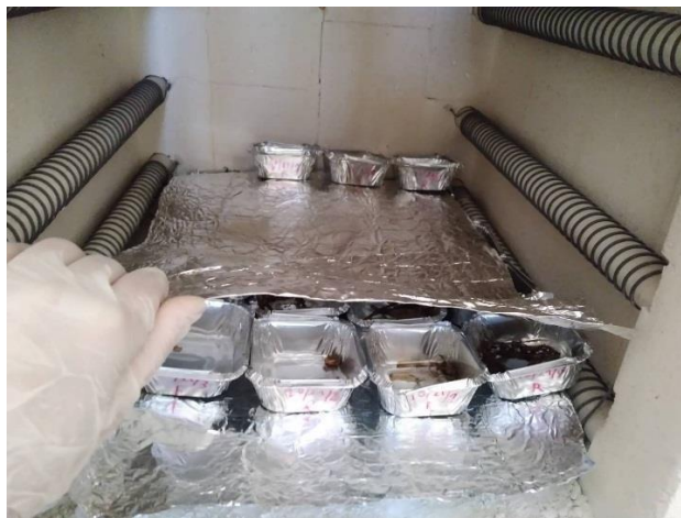
Figure III.12 : Minéralisation les racines et/feuilles a été mise dans un four à 500 C°.
