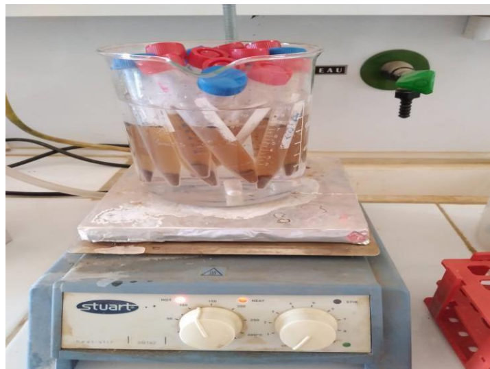
Figure III.10 : Extraction du chrome hexavalent à partir des échantillons de sol
