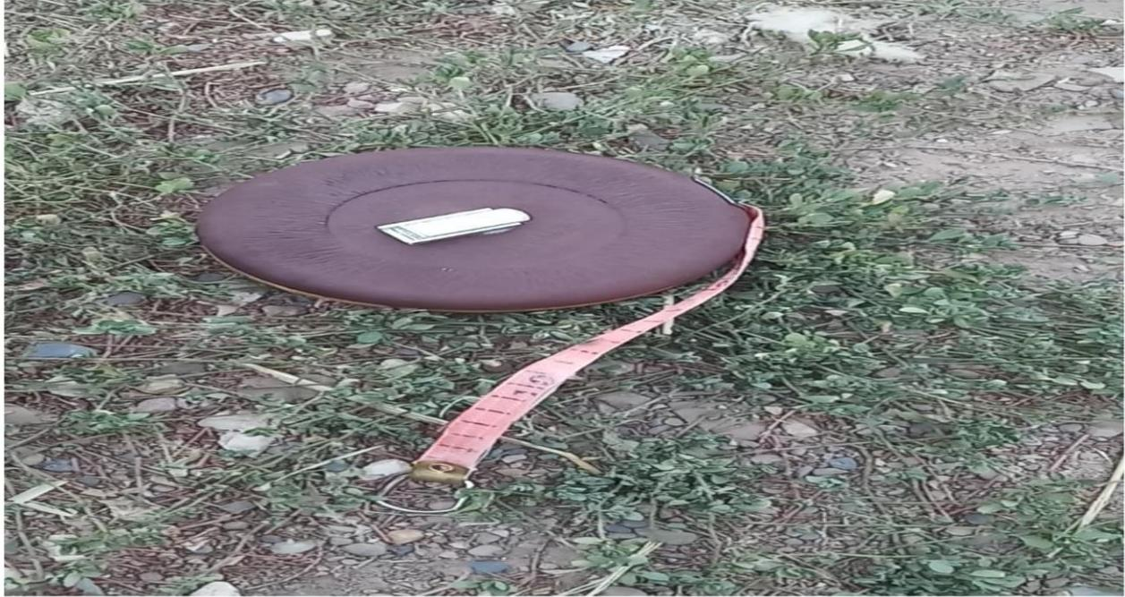
**Photo N°05:** Un ruban mètre de 20 m utilisé pour déterminer la surface du relevé
