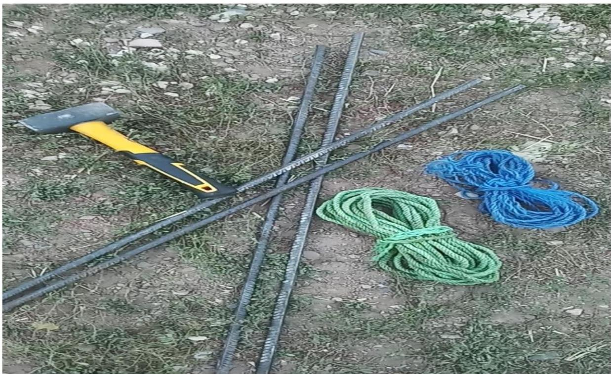
**Photo N°06 :** Piquets en fer, la corde et le marteau utilisés dans la délimitation de la surface du relevé (ORIGINALE.,2022)
