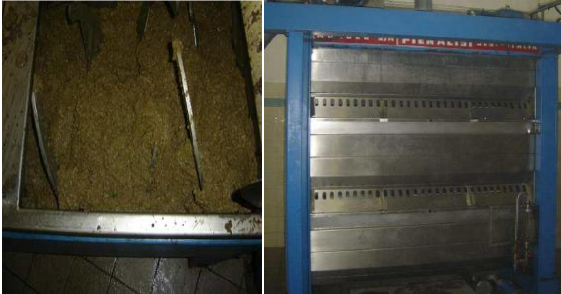
Figure 11 : Bacs de malaxage (a) unique, (b) trois bacs en série (SÉBASTIEN, 2010).
