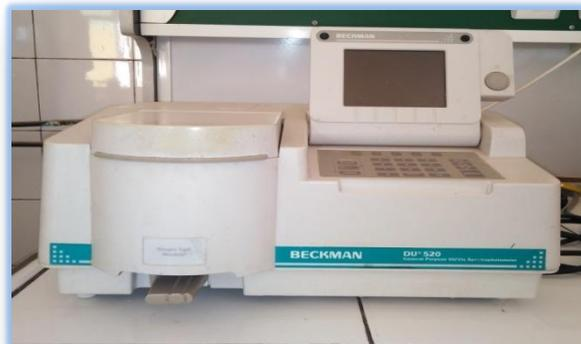
**Figure III.03** : Spectrophotomètre (UV-Visible)
