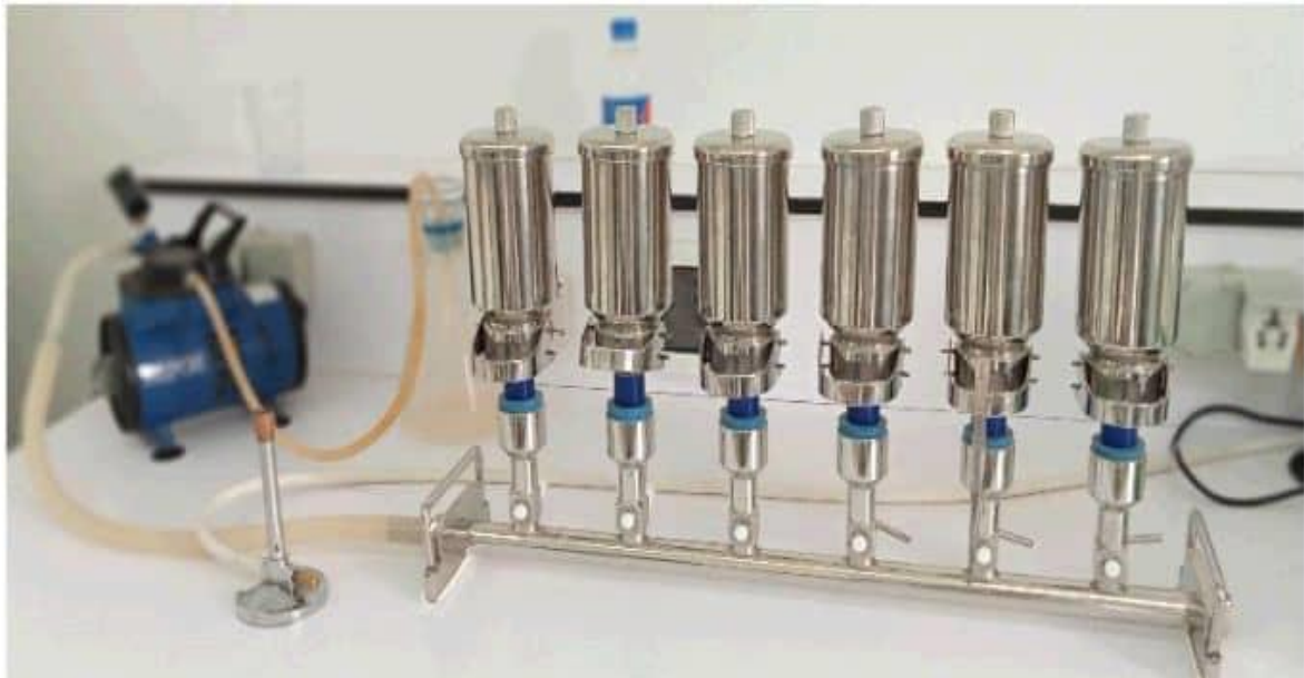
Figure 4 : Rampe de filtration (PHOTO ORIGINALE , 2022 )
