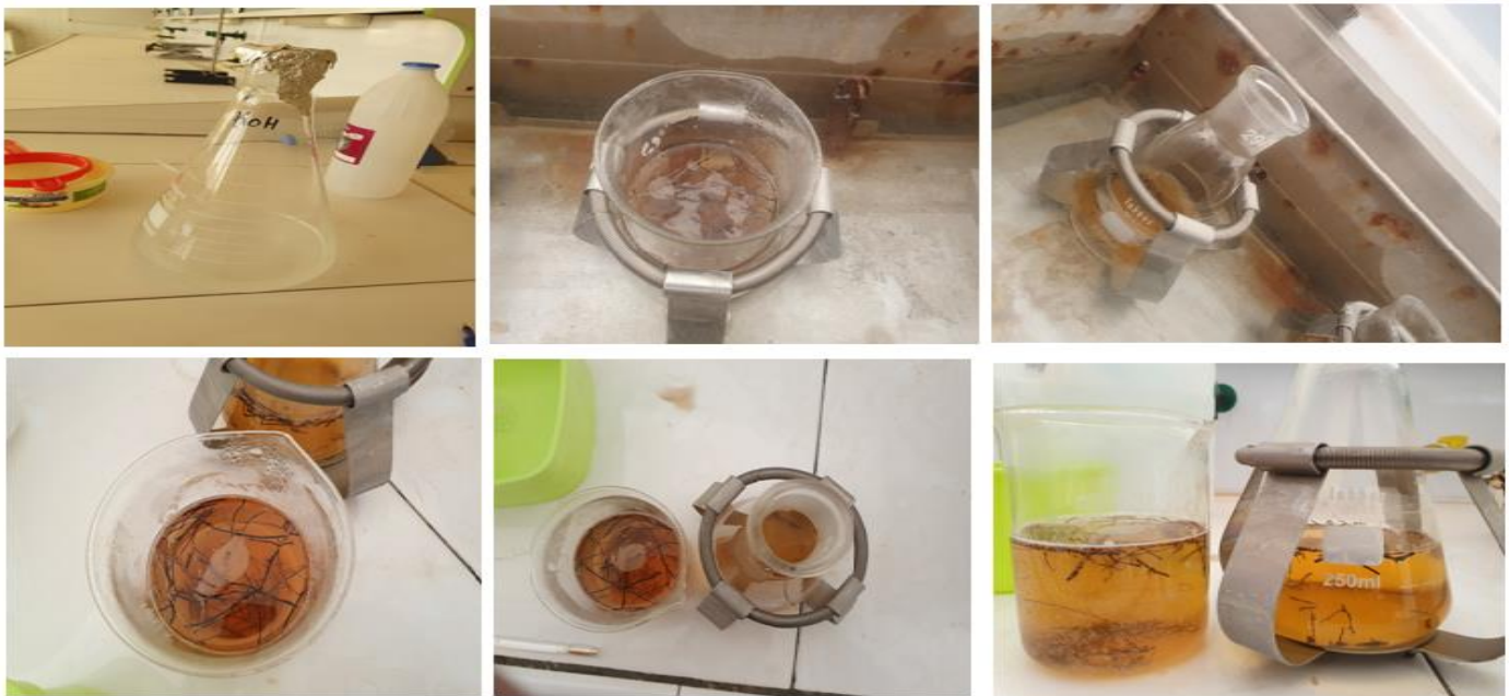
Figure 26: Eclaircissement des racines au KOH à 90°C
