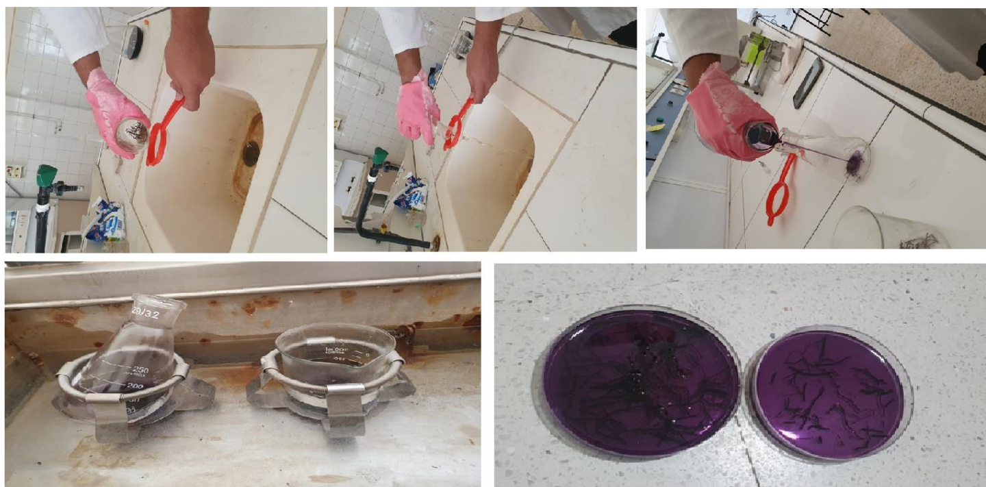
Figure 27: Lavage des racines et mettre le bleu coton et les remettre dans le bain marie
