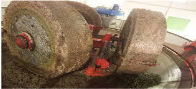
Figure 6: Broyage à l'aide de la meule
