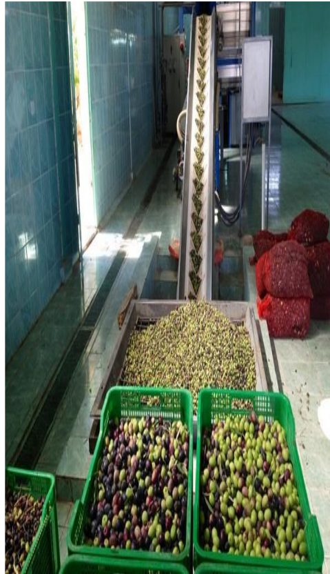
Figure 5: Lavage des olives et alimentation en olive de broyeur
