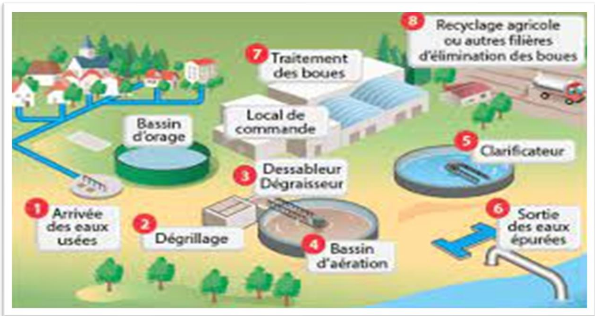
Figure 22, Schéma expliquant les étapes de l'opération d'épuration des eaux usées
