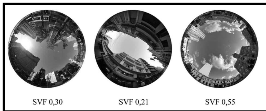
Figure N° 5: Exemples de facteurs de vue du ciel (Sky View Factor donc SVF en anglais) pris avec un objectif fish-eye à Curitiba au Brésil.. Source : Krüger et al. (2011)
