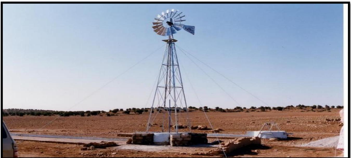
Photo 3 : Equipement éolien d'un point d'eau
