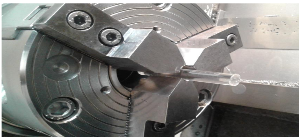
Fig.III.05 : Photo d'éprouvettes de PMMA pendant le processus de tournage.
