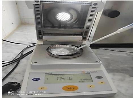
**Figure 15 : Détermination de l'extrait sec total par dessiccateur**
