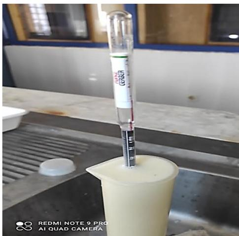
**Figure 13 : Mesure de la densité par lactodensimètre**
