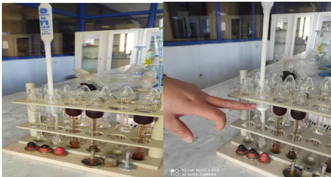
**Figure 14 : déterminé la matière grasse par ma méthode GERBER**
