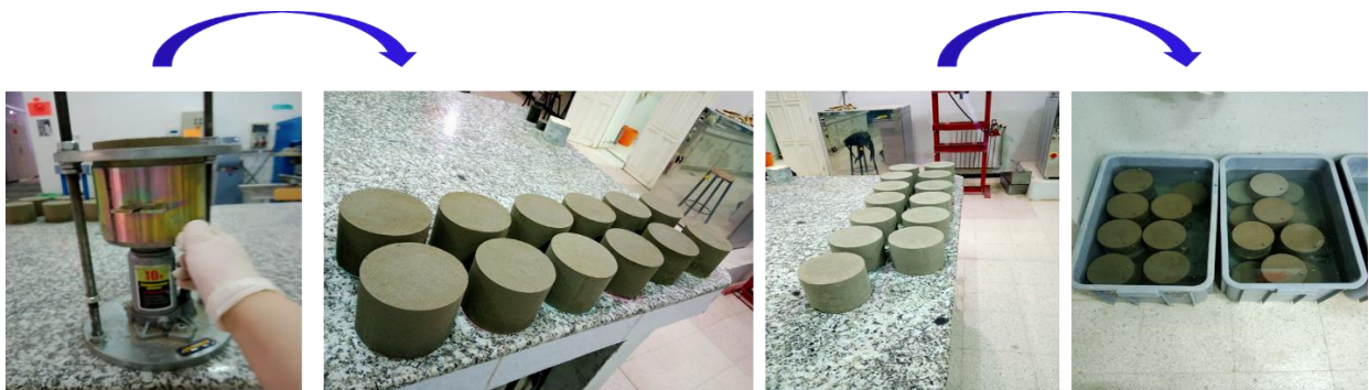
Figure III.18: Démoulage et conservation des éprouvettes de BSCR.
