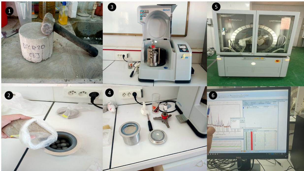
Figure III.24 : Etapes de réalisations de l'essai DRX.
