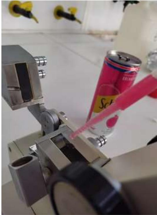
**Figure 18 :** Placement une goutte de liquide sur la surface du prisme (réfractomètre) (photo personnelle, 2023)
