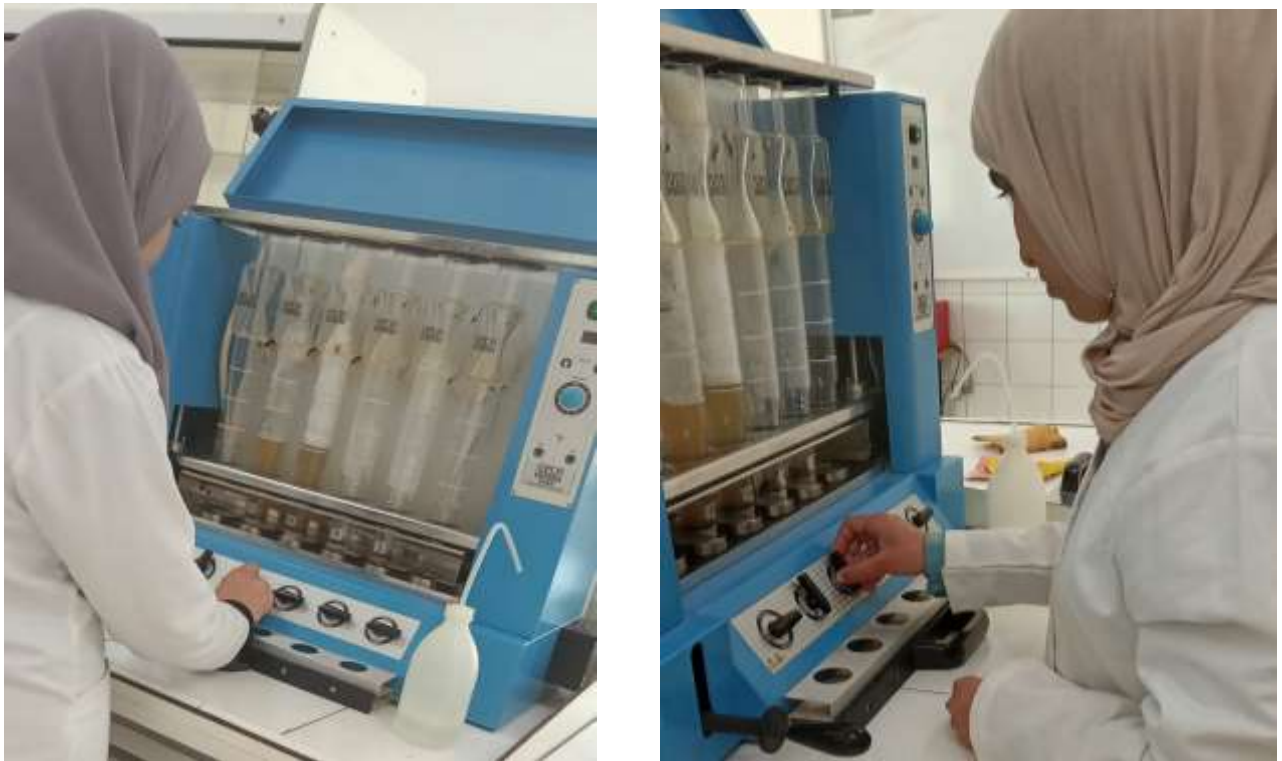
Figure 18 : Détermination de la cellulose brute CB par la méthode de WEENDE.
