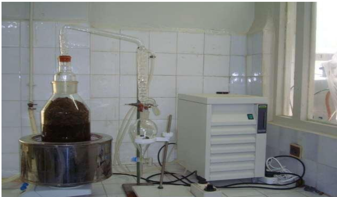
Figure 01. Montage d'extraction par la technique d'hydrodistillation (Atmani-Merabet, 2018)
