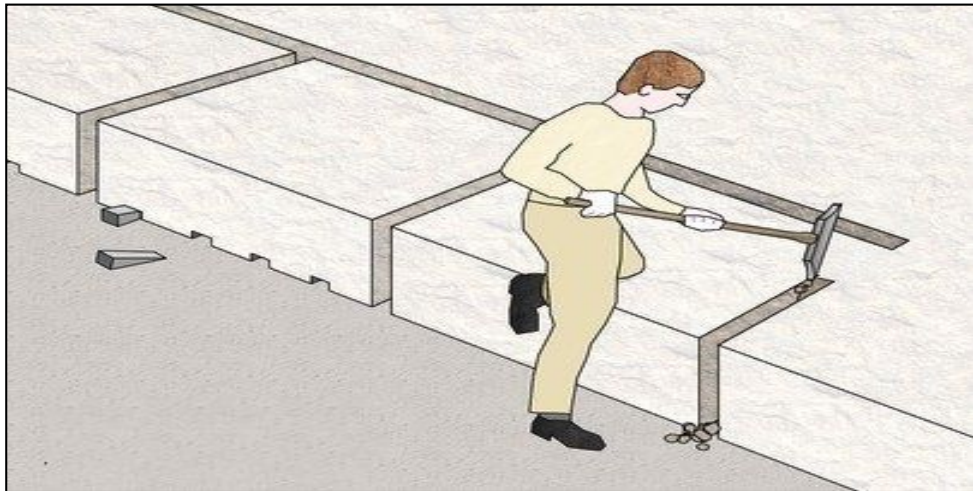
الشكل 03 : عملية حفر القنوات و الممرات 2
