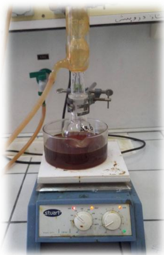
Figure 23 : Le montage de la réaction de Ligand.
