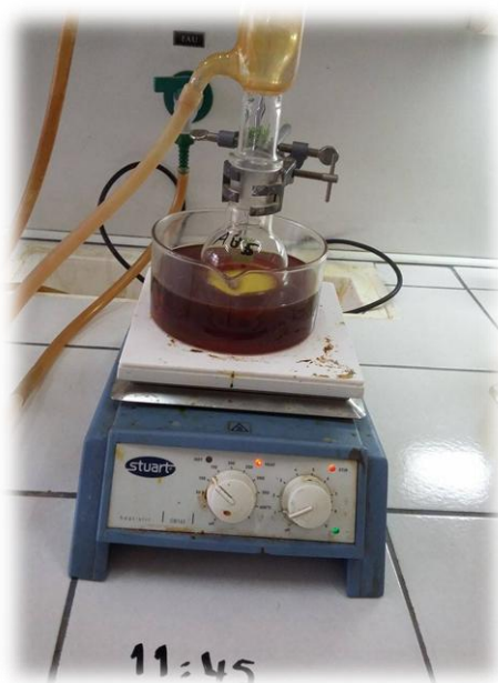
Figure 25: La réaction du complexe porté au reflux
