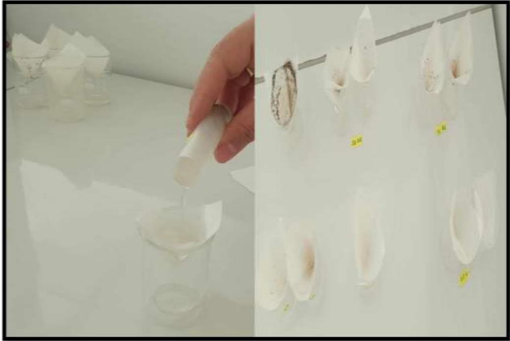
**Figure 16.** Isolement des spores par distillation (Originale,2024).
