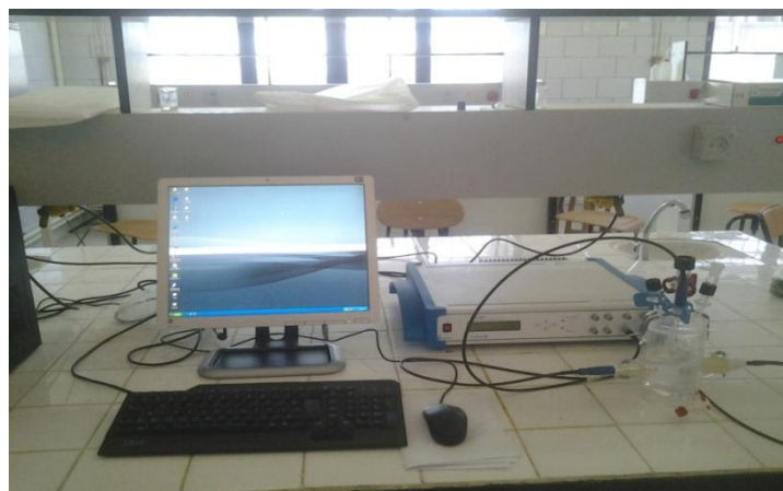
Figure III.6 : Dispositif expérimental de la technique potentiostatique
