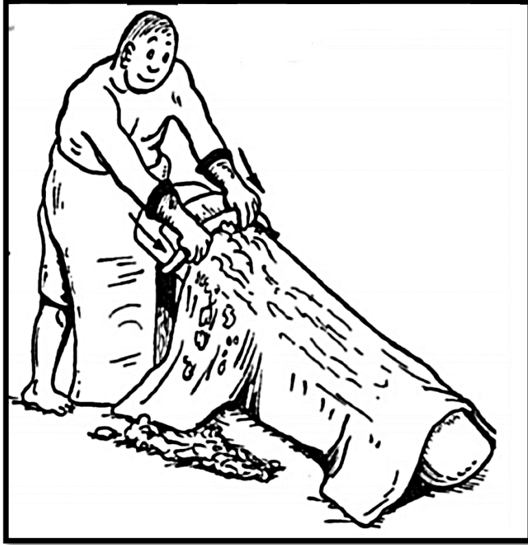
الشكل رقم (05): عملية إزالة الشعر من الجلد وصقله
