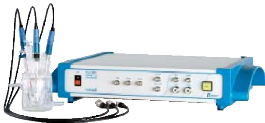
Figure II.2: Schéma représente l'instrument électrochimique PGP201 Potentiostat.
