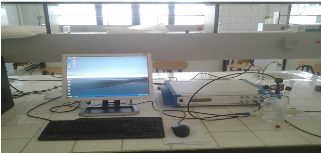
Fig. IV .2. Dispositif expérimental de la technique potentiostatique.
