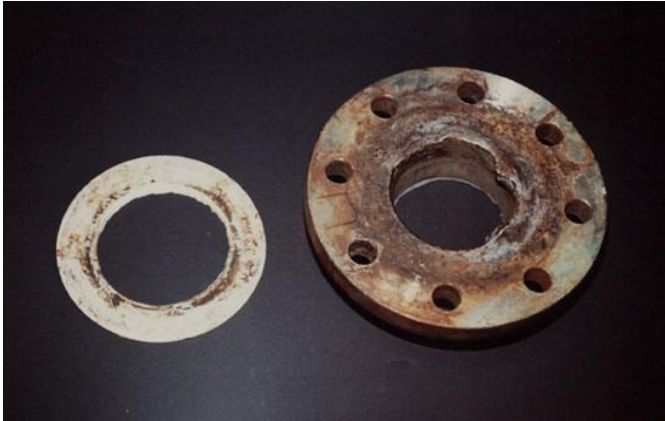
Fig. (I.6): corrosion caverneuse d'un acier allié sous un joint.
