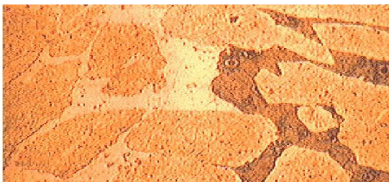
Fig. (I.9): coupe métallographique montrant une corrosion sélective d'un laiton.
