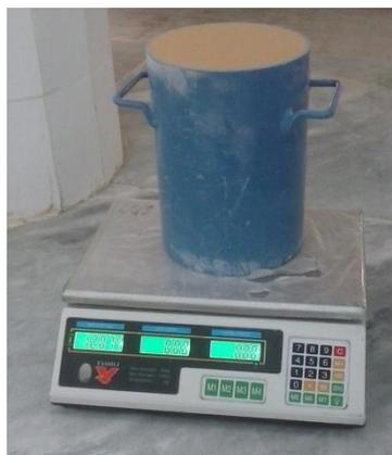
Photo 3.6 : Essai de la compacité des sables
