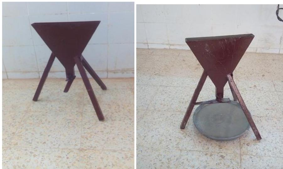
**Photo 3.9 : Essai de Temps d'écoulement au mini entonnoir à mortier**
