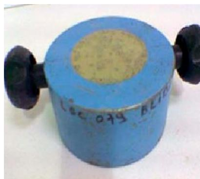
Figure 1.3 : Étalement au Mini cône de mortier [Benchaa.2014]
