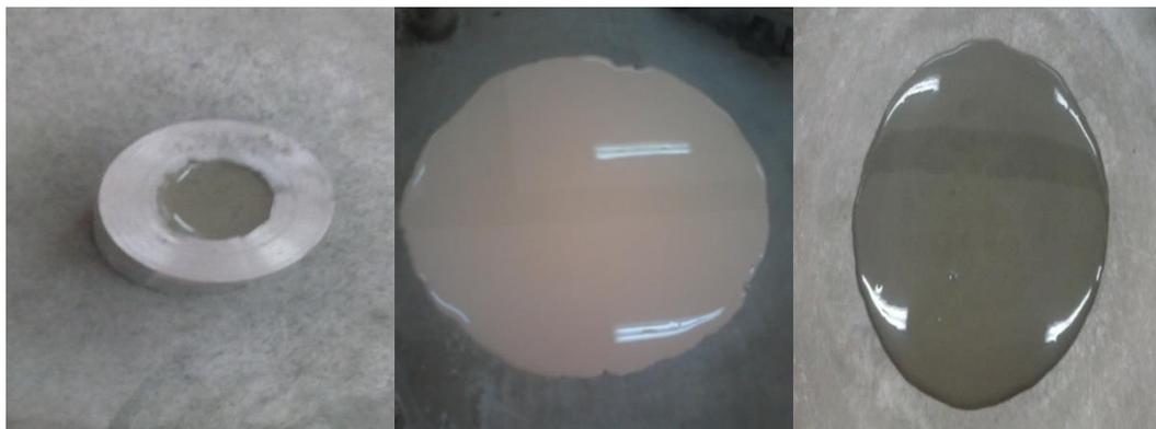
Photo 1.2 : Étapes de l'essai d'étalement au Mini cône de pâte
