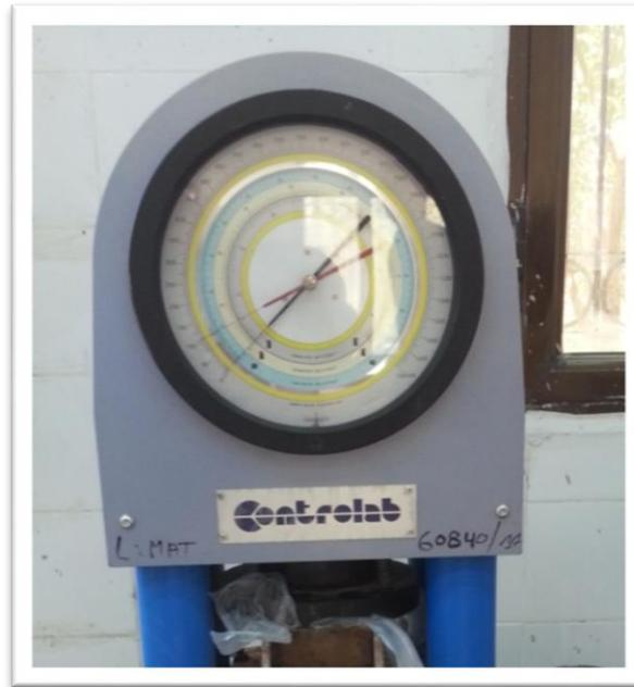
**Fig. 2. 16.** *appliqué contrainte de compactage (5 MPa)*
