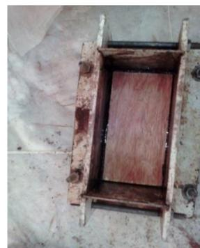
**Fig.2.9.***moule utilisé pour la fabrication des BTC*
