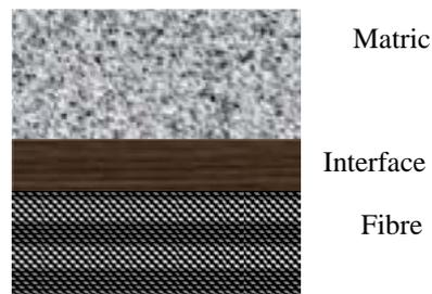
**Fig 1.32.** Représentation schématique d'une interface
