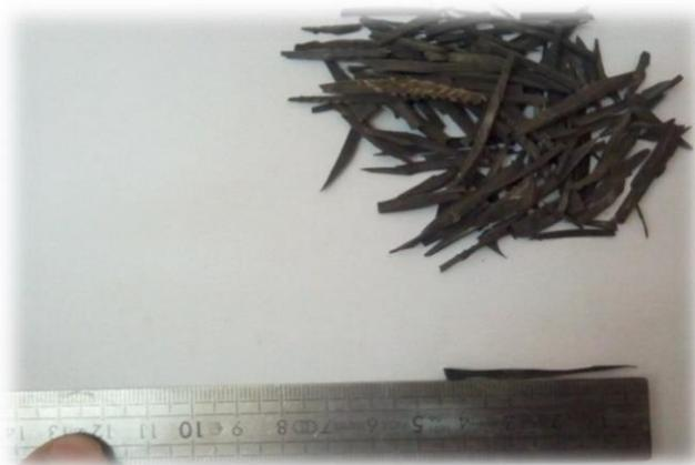
**Fig.2.6.** Les fibres découpées en morceaux
