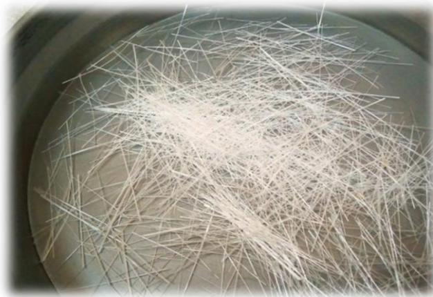
**Fig.2.7 :** *Fibre de verre utilisée de type Cemfil (A.R)*
