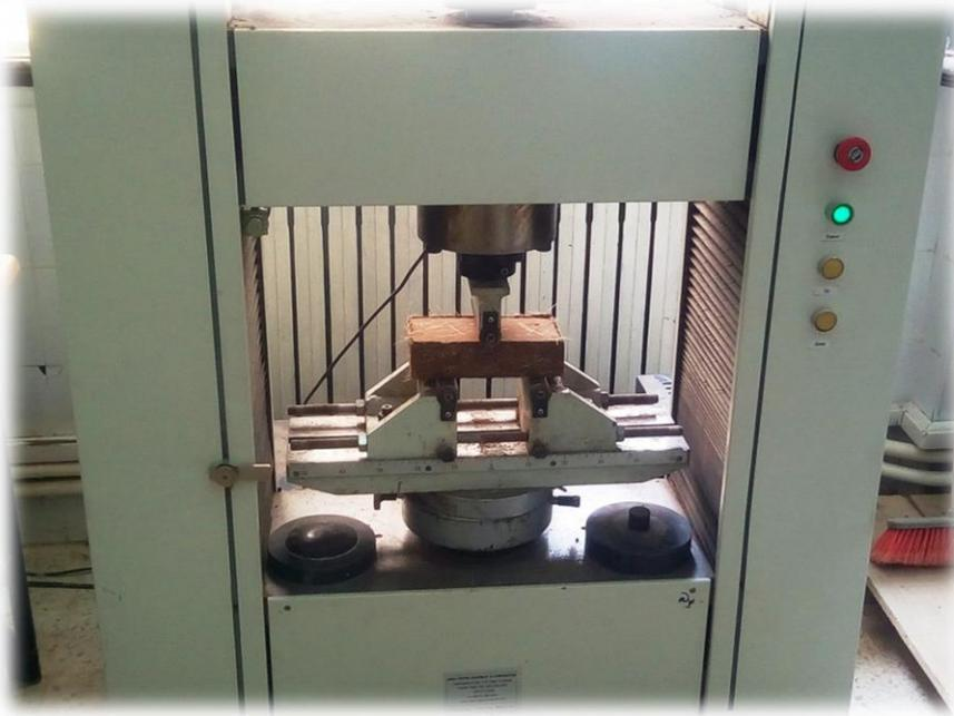
Essai de traction par flexion
