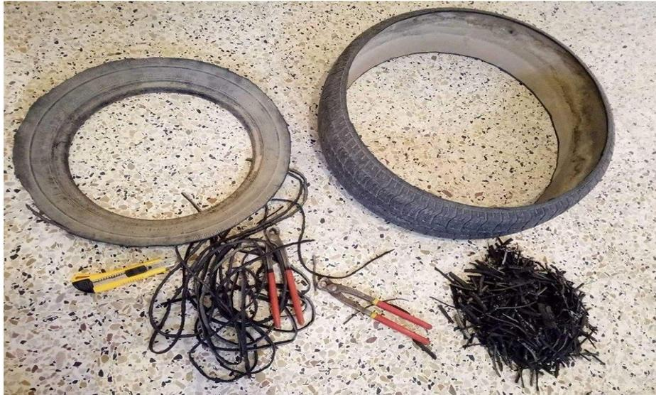
**Fig.1.28.**Fibres des pneus de caoutchouc
