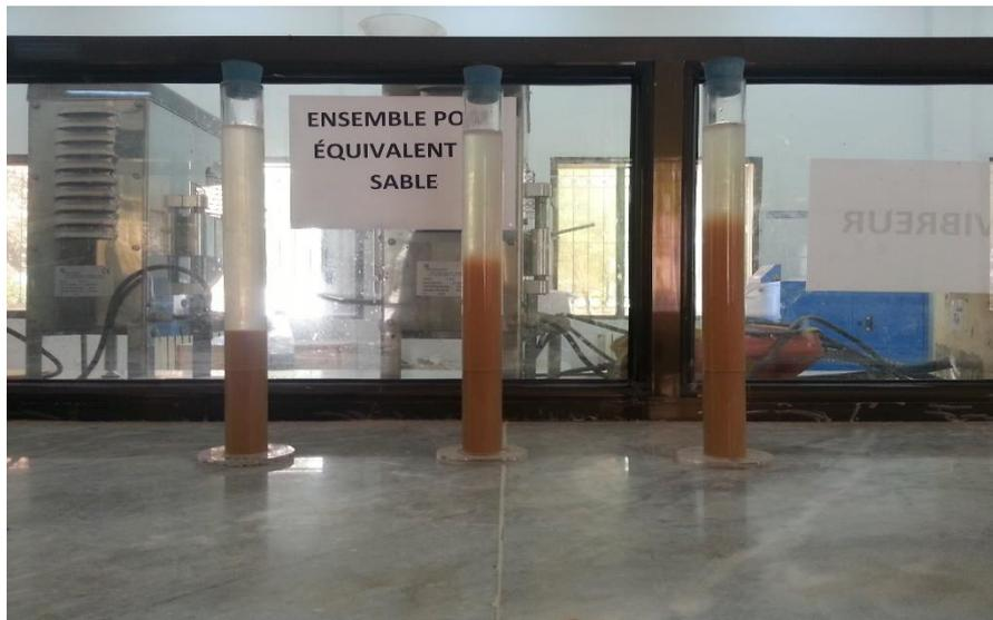
**Fig. 2.5 :** *Essai équivalent de sable*
