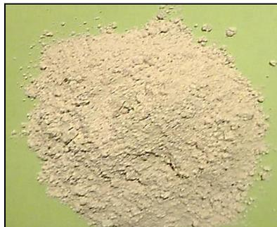
**Figure III.1.** Filler calcaire utilisé
