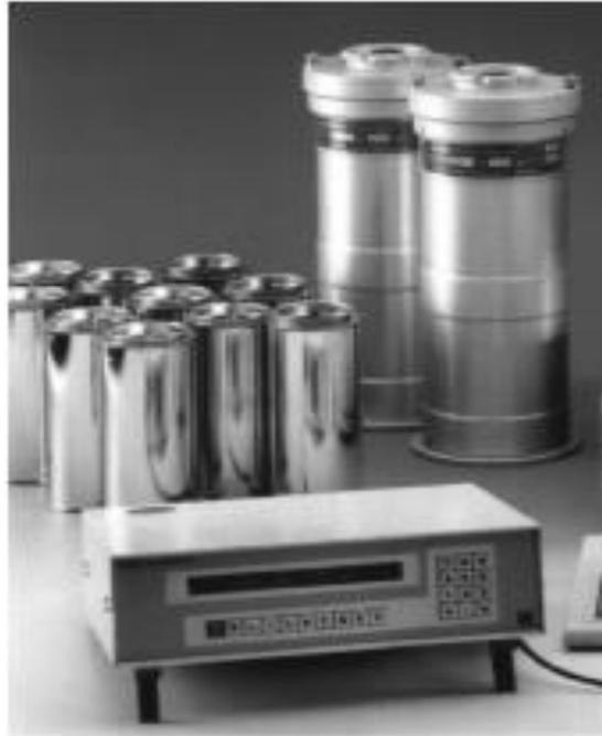
**Figure II.1:** Le calorimètre de Langavant
