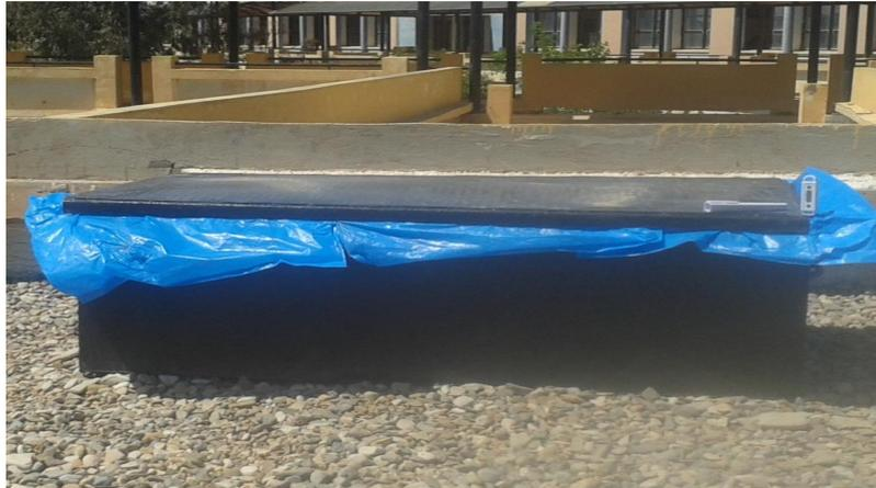
**Figure IV.3.** Enceinte d'étuvage exposée aux rayons solaires
