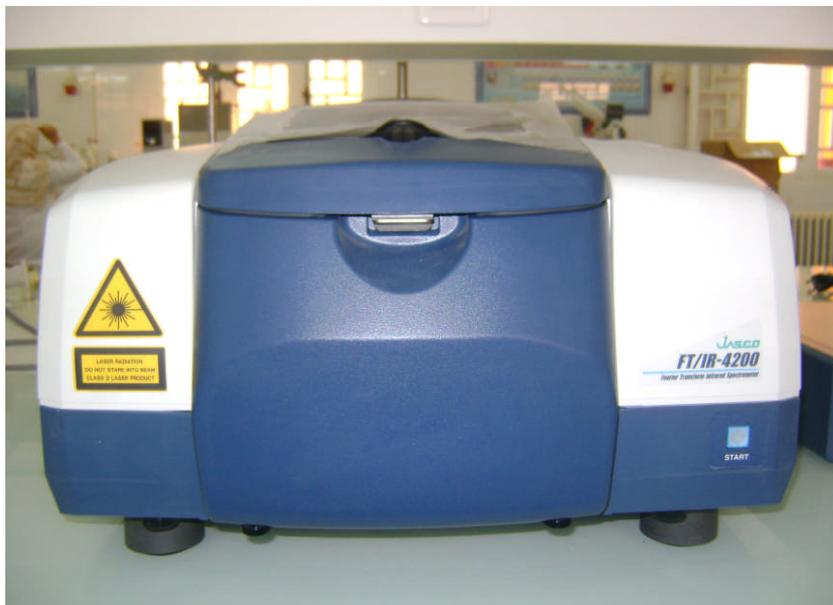
**Figure I-13** : Spectromètre Jasco FT/IR-4200 (ATR)
