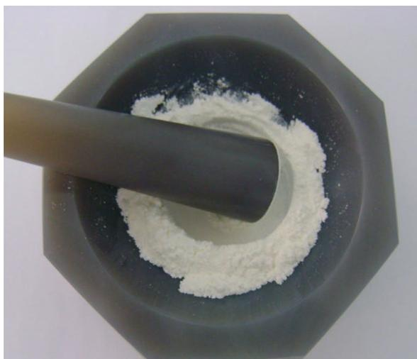
Figure II-10 : Mélange des produits au départ par le mortier agate
