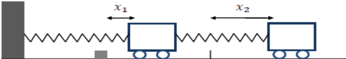
Figure I.9 : Système composé par deux chariots, exprimé par un modèle hybride de type LC.
