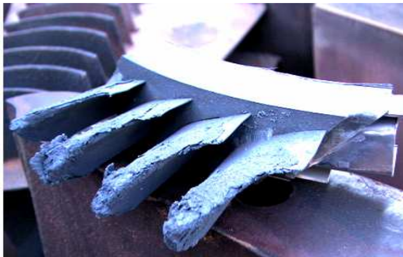
Figure IV.20:Usure des ailettes d'une turbine à gaz
